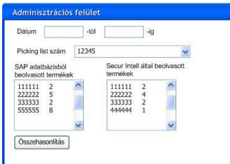
4.ábra Vonalkódok összehasonlító felülete (vázlat – a listákban SSCC kódok és mennyiség szerepel)
